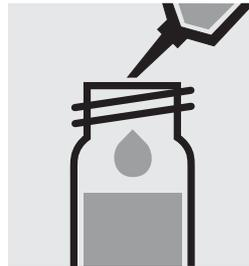
Ajouter 1,0 ml de **H-1K** à la pipette, fermer avec le bouchon fileté et mélanger.
