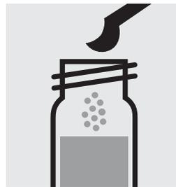
Ajouter 1 microcuiller grise de **TOC-2K**. Boucher **immédiatement** et hermétiquement le tube avec le bouchon **en aluminium** (art. 252038).
