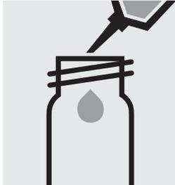
Pipetter 10 ml d'échantillon dans un tube.
