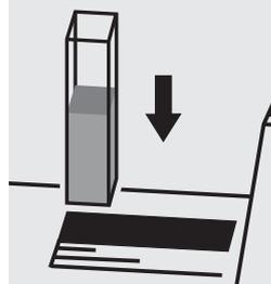
Placer la cuve dans le compartiment, sélectionner la méthode n° 301.
