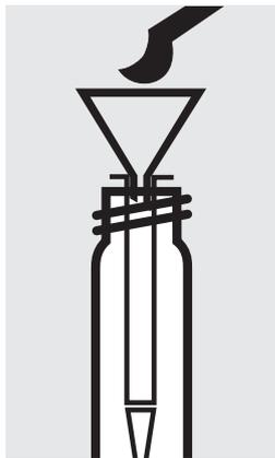
Mettre la colonne dans un tube vide (tubes vides, art. 250621), placer l'entonnoir en verre, verser 1 micro-cuiller bleue arasée de **AOX-1**.
