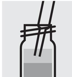
A l'aide d'une pipette Pasteur, aspirer la couche claire supérieure colorée et dessécher sur **sulfate de sodium anhydre pour analyses**.
