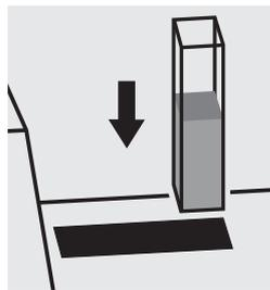
Placer la cuve dans le compartiment. Sélectionner la méthode n° 015 ou 061 ou 078.
