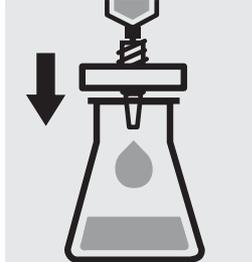
Filtrer la solution à doser sur une membrane filtrante taille de pores 0,45  $\mu\text{m}$ .
