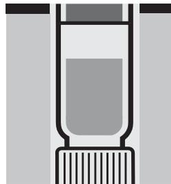
Chauffer le tube placé la tête en bas 2 heures à 120 °C dans le thermoréacteur.
