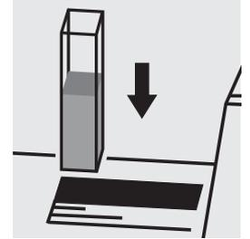
Placer la cuve dans le compartiment. Sélectionner la méthode n° 2503.
