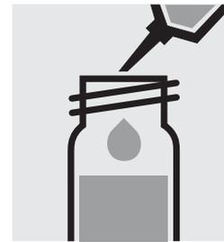
Ajouter 5,0 ml d'échantillon à la pipette, fermer avec le bouchon fileté et mélanger.
