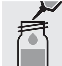
Ajouter 1,0 ml de **OA-5** à la pipette, fermer avec le bouchon fileté et agiter vigoureusement.
