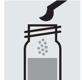
Ajouter 1 microcuiller bleue arasée de **CN-4**, fermer avec le bouchon fileté.
