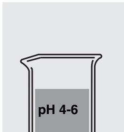
Vérifier la valeur de pH de l'échantillon. Plage de consigne: pH 4-6. Si nécessaire, corriger avec de l'acide sulfurique dilué ou de la potasse caustique.
