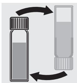
Mélanger le contenu en retournant le récipient, jusqu'à dissolution du comprimé.
