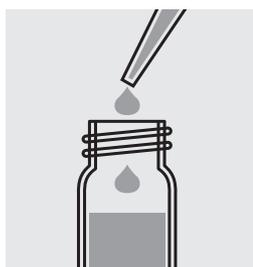
Pipeter **avec précaution** 2,0 ml d'échantillon dans le tube, le fermer au moyen du couvercle fileté et mélanger vigoureusement.
