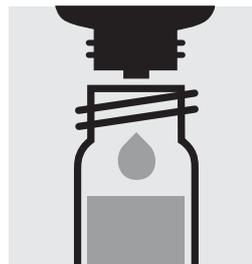
Ajouter 3 gouttes de **Zn-4**, fermer avec le bouchon fileté et mélanger.
