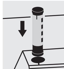
Sélectionner la méthode 0,5–50,0 mg/l de Si avec l'AutoSelector.
