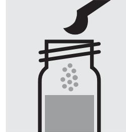
Ajouter 1 microcuvette verte arasée de **Ag-2**, fermer avec le bouchon fileté.
