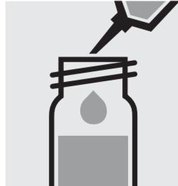
Pipetter **prudemment** 1,0 ml d'échantillon dans un tube à essai, fermer hermétiquement avec le bouchon fileté et mélanger vigoureusement. **Attention, le tube devient brûlant.**
