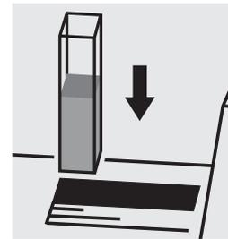
Placer la cuve dans le compartiment et refaire la mesure
