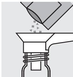
Verser le contenu d'un sachet de poudre de **Total N Persulfate RGT** dans un tube à dissolution **Total Nitrogen Hydroxide LR Tube**.
