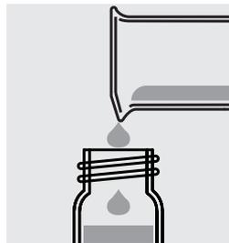
Remplir un tube vide avec l'échantillon préparé et fermer avec le couvercle fileté.
