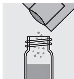
Ajouter le contenu d'un sachet de poudre de **VARIO Silica HR Acid Rgt F25** et fermer le tube avec le couvercle fileté.
