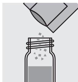
Ajouter le contenu d'un sachet de poudre de **VARIO Molybdenum HR2 F10** et fermer le tube avec le couvercle fileté.
