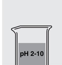
Vérifier la valeur de pH de l'échantillon. Plage de consigne: pH 2-10. Si nécessaire, corriger avec de l'acide chlorhydrique dilué ou de la soude liquide diluée.
