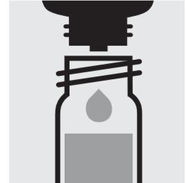
Ajouter 6 gouttes de **K-1K**, fermer avec le bouchon fileté et mé-langer.
