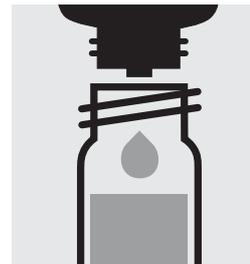
Ajouter 2 gouttes de **réactif 3**, fermer avec le bouchon fileté et mélanger.
