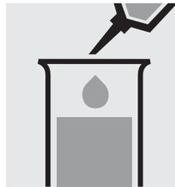
Pipetter 5,0 ml de  $\text{NH}_4\text{-1}$  dans une éprouvette.
