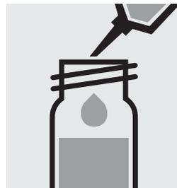
Ajouter 1,0 ml de **OA-4K** à la pipette, fermer avec le bouchon fileté et agiter vigoureusement.
