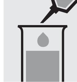
Ajouter 0,60 ml de **NH<sub>4</sub>-1** (provenant du test Ammonium, art 250426 ou 252081) à la pipette et mélanger.
