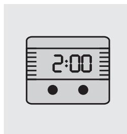
Laisser reposer 2 minutes. S'il y a du SiO<sub>2</sub> dans l'échantillon, la solution vire au bleu.
