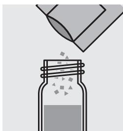
Ajouter le contenu d'un sachet de poudre de **Nitrate Chromotropic** et fermer le tube avec le couvercle fileté.
