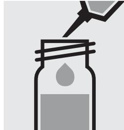
Pipetter 0,50 ml l'échantillon dans un tube à essai, fermer avec le bouchon fileté et mélanger.
