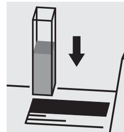
Placer la cuve dans le compartiment. Sélectionner la méthode n° 2517 ou 2518.
