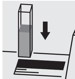
Placer la cuve dans le compartiment, sélectionner la méthode n° 33.
