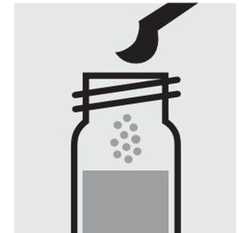
Ajouter 1 microcuiller verte arasée de **Ph-2K**, fermer avec le bouchon fileté.
