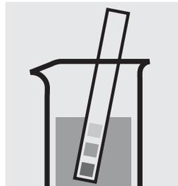
Vérifier le pH de l'échantillon. Domaine nécessaire: pH 3–12
