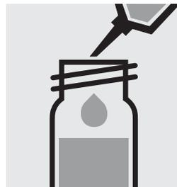
Ajouter 1,0 ml de **OA-4** à la pipette, fermer avec le bouchon fileté et mélanger.
