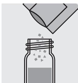
Ajouter le contenu d'un sachet de poudre de **VARIO Manganese Citrate Buffer F10** et fermer le tube avec le couvercle fileté.
