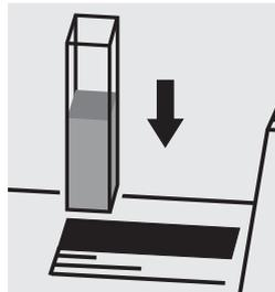
Placer la cuve dans le compartiment, sélectionner la méthode n° 300.
