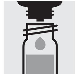
Ajouter 1 goutte de **Ag-4**, fermer avec le bouchon fileté et mélanger.
