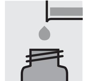
Ajouter env. 30 ml d'**éthanol** (w = 90 %) en ébullition et laisser refroidir à la température ambiante.
