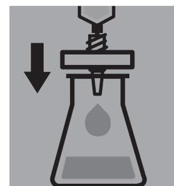
En opérant à **l'abri de la lumière**, filtrer l'extrait par un filtre adéquat un peu d'éthanol.
