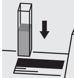
Placer la cuve dans le compartiment, sélectionner la méthode n° 302.
