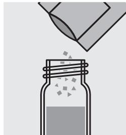
Ajouter le contenu d'un sachet de poudre de **VARIO Cu1 F10** et fermer le tube avec le couvercle fileté.
