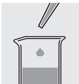
Ajouter 0,5 ml de **VARIO DEHA 2 RGT** avec une pipette et mélanger.
