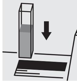
Placer la cuve dans le compartiment. Sélectionner la méthode n° 32.
