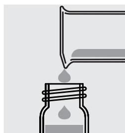
Remplir un tube vide avec de l'échantillon préparé, fermer avec le couvercle fileté **et mettre dans l'obscurité.**
