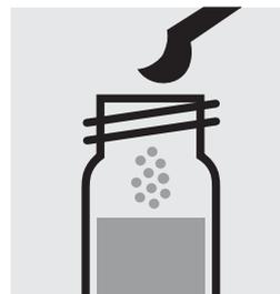
Ajouter 1 microcuiller verte arasée de  $\text{SO}_4-2$ , fermer avec le bouchon fileté et mélanger.
