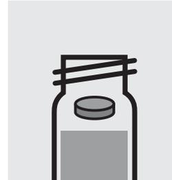
Ajouter 1 comprimé de **Cyanuric Acid**, écraser avec la baguette d'agitation et fermer avec le bouchon fileté.
