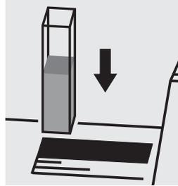
Placer la cuve dans le compartiment, sélectionner la méthode n° 77.
