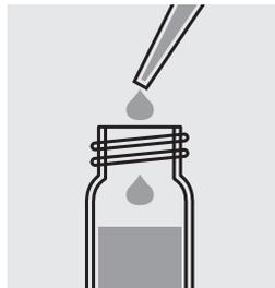
Pipeter **avec précaution** 0,2 ml d'échantillon dans le tube, le fermer au moyen du couvercle fileté et mélanger vigoureusement.
