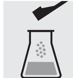
Ajouter 2 microcuillères rouges arasées de **As-7** à la solution dans l'erlenmeyer et mélanger. Placer **immédiatement** le tube d'absorption sur l'erlenmeyer.
