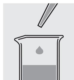
Avec une pipette, ajouter 15,0 ml d'eau désionisée et mélanger.
