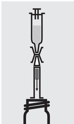
Mettre l'embout à la partie inférieure de la colonne. A l'aide d'une seringue plastique, rincer le charbon de la colonne avec 10 ml de **AOX-5** dans un tube vide (tubes vides, art. 250621).
