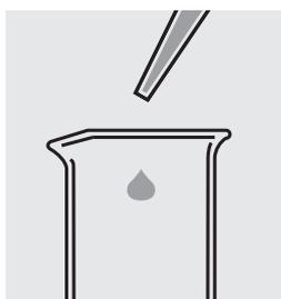
Avec une pipette, mettre 25,0 ml d'échantillon dans un bécher vide.
