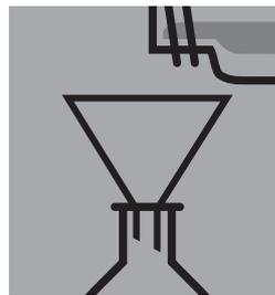
En opérant à **l'abri de la lumière**, filtrer l'extract par un filtre en papier (« Blauband ») dans un ballon jaugé (analogue à DIN 38412 : 100 ml). Rincer le filtre avec un peu d'éthanol.
