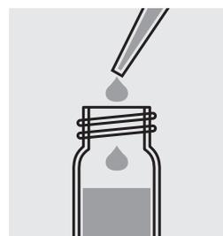
Ajouter avec une pipette 2,0 ml de **VARIO Sodium hydroxide 1,54N**, fermer le tube au moyen du couvercle fileté et mélanger.
