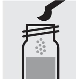
Ajouter 1 microcuiller grise arasée de **SO<sub>3</sub>-1K** dans un tube à essai, fermer avec le bouchon fileté.
