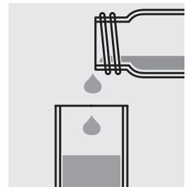
Mettre la solution dans le tube de mesure.
