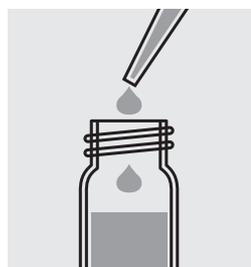
Pipeter 2,0 ml d'échantillon préparé dans un tube à réaction **Total Nitrogen Acid LR (Reagent C)** et fermer le tube avec le couvercle fileté.
