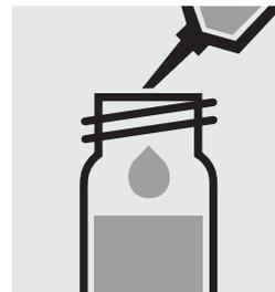
Ajouter 1,5 ml **d'échantillon préparé** à la pi-pette lentement, fermer hermétiquement avec le bouchon fileté et mélanger brièvement. **Attention, le tube devient brûlant.**
