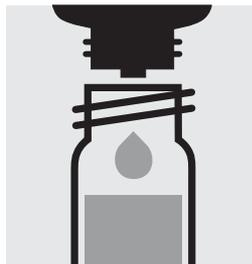
Ajouter 5 gouttes de **P-2K**, fermer avec le bouchon fileté et mélanger.
