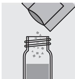
Ajouter le contenu d'un sachet de poudre de **VARIO Molybdenum HR1 F10** et fermer le tube avec le couvercle fileté.
