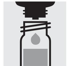
Ajouter 5 gouttes **AOX-4**, boucher avec le bouchon fileté et mélanger. Faire décantier le charbon actif. solution surnageante: **échantillon préparé.**
