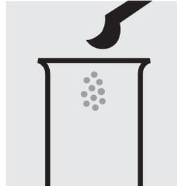
Verser 1 microcuiller grise arasée de  $\text{SO}_3\text{-1}$  dans une éprouvette sèche.
