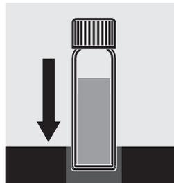
Dans les 8 minutes suivant le dernier ajout de réactif: Mettre le tube dans le porte-tube du photomètre et lancer la mesure.
