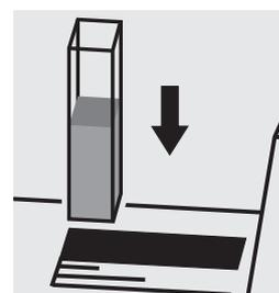
Insérer le tube dans le porte-tube du photomètre en l'espace d'une minute et lancer la mesure.
