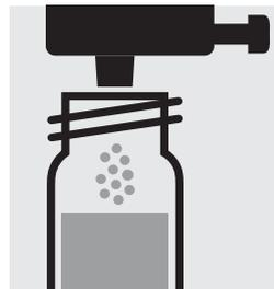
Ajouter 1 dose de **P-3K** avec le capuchon doseur bleu, fermer avec le bouchon fileté.
