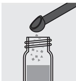
Ajouter 1 cuiller de mesure noire No 8 (pleine à ras) de **Nitrit 101** et fermer le tube au moyen du couvercle fileté.
