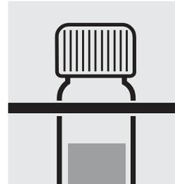
Retirer le tube du thermostateur, le laisser refroidir dans un support d'éprouvettes.
