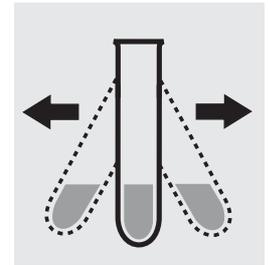
Agiter vigoureusement l'éprouvette pour dissoudre la substance solide.
