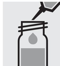
Ajouter 0,20 ml de **Oxyscav 2** à la pipette, fermer avec le bouchon fileté et mélanger.
