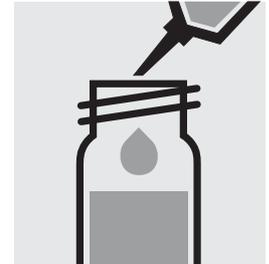
Ajouter 0,25 ml de **Al-2K** à la pipette, fermer avec le bouchon fileté et mélanger.
