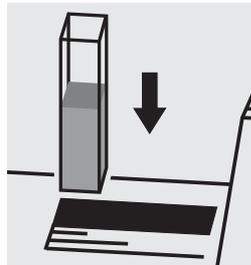
Placer la cuve dans le compartiment, sélectionner la méthode n° 182.
