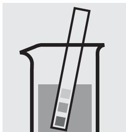
Vérifier le pH de l'échantillon. Domaine nécessaire: pH 2–10. Si nécessaire, ajuster le pH en ajoutant goutte à goutte du sodium hydroxyde en solution ou de l'acide chlorhydrique dilués.
