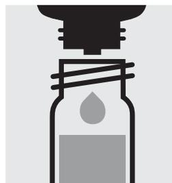
Mélanger le filtrat avec 4 gouttes de  $\text{SO}_4-4$  et fermer avec le bouchon fileté.
