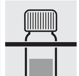
Retirer le tube du thermoréacteur, le laisser refroidir à température ambiante dans un support d'éprouvettes.
