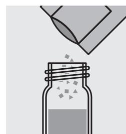
Ajouter le contenu d'un sachet de poudre de **VARIO Sodium Periodate** et fermer le tube avec le couvercle fileté.
