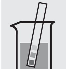
Vérifier le pH de l'échantillon. Domaine nécessaire: pH 2–5. Si nécessaire, ajuster le pH en ajoutant goutte à goutte du sodium hydroxyde en solution ou de l'acide sulfurique dilués.
