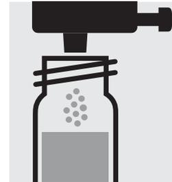
Ajouter 1 dose de **NH<sub>4</sub>-1K** (provenant du test Ammonium, art 250329) avec le capuchon doseur bleu, fermer avec le bouchon fileté.
