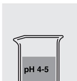
Vérifier la valeur de pH de l'échantillon. Plage de consigne: pH 4-5. Si nécessaire, corriger avec de l'acide nitrique dilué ou de la soude liquide diluée.
