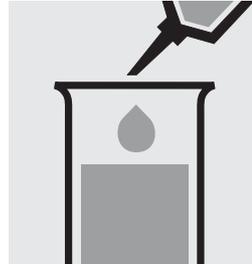
Pipetter 5,0 ml d'échantillon dans une éprouvette.
