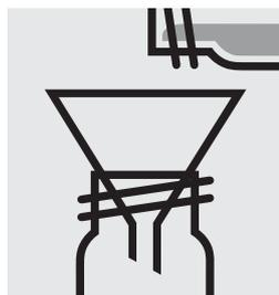
Filtrer à travers un filtre rond dans un tube à col à vis avec le bouchon fileté.
