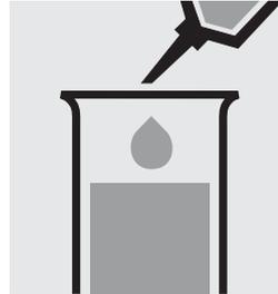
Pipetter 8,0 ml d'échantillon dans une éprouvette.
