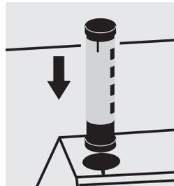
Sélectionner la méthode 2,0 – 75,0 mg/l de  $\text{NH}_4\text{-N}$  avec l'AutoSelector.
