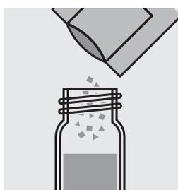
Ajouter le contenu d'un sachet de poudre de **VARIO Ferro F10** et fermer le tube avec le couvercle fileté.
