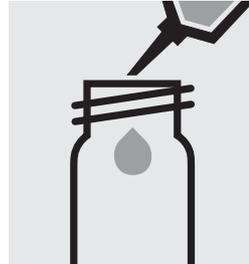
Pipetter 10 ml d'échantillon dans un tube vide (tubes vides, art. 250621).
