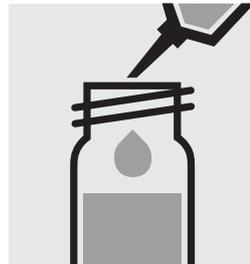
Ajouter 1,0 ml d'échantillon à la pipette. **Attention, le tube devient brûlant.**
