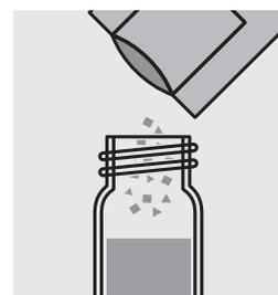
Ajouter le contenu d'un sachet de poudre de **VARIO Phosphate RGT F10 ml** et fermer le tube avec le couvercle fileté.
