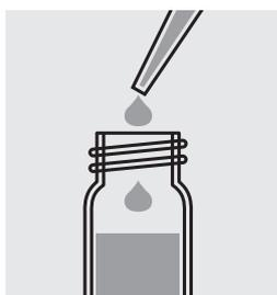
Pipeter 1,0 ml d'échantillon dans un tube de réaction et fermer le tube au moyen du couvercle fileté.
