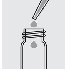
Pipeter 0,50 ml de SO<sub>4</sub><sup>-1</sup> dans le tube vide.
