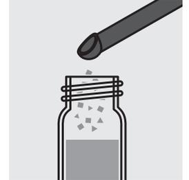
Ajouter 1 microcuiller bleue (pleine à ras) de SO<sub>4</sub><sup>-2</sup> et fermer le tube avec le couvercle fileté.
