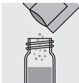
Ajouter le contenu d'un sachet de poudre de **Chlorine Total-DPD F10** et fermer le tube avec le couvercle fileté.
